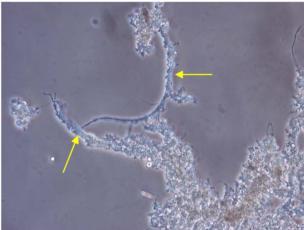
Abb. 5: Die Ansiedlung flocculbildender Bakterien an die Fadenbakterien bzw. die Einbindung in die Flocken (Pfeile) sind unter natürlichen Bedingungen nicht möglich und im vorliegenden Fall auf die Wirksamkeit des VTA-Systemproduktes zurückzuführen (200fache Vergrößerung).
