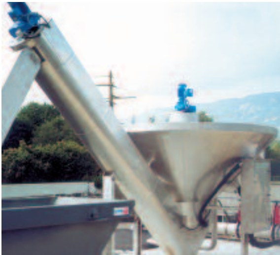
Innovative Technik: COANDA Sandwaschanlage Typ: RoSF 4 / BG III, beheizte Ausführung für den Betrieb im Freien.
