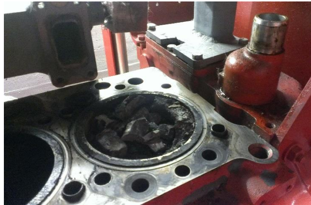
Defekter Kolben mit div. Bruchstücken nach Demontage Zylinderkopf am 06.06.2014
