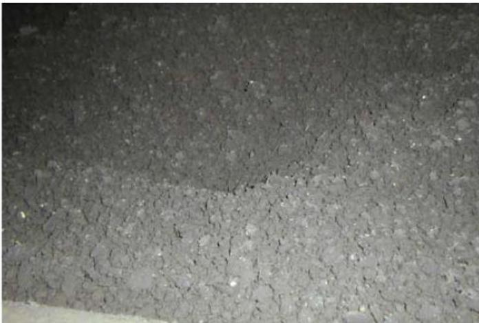
Beispiel eines entwässerten Faulschlammes (Wasseranteil immer noch ca. 70 %)
