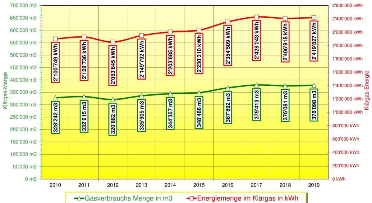
Mit der Installation des neuen BHKW war die Hoffnung auf einen besseren Wirkungsgrad verbunden. Die Betriebserfahrungen zeigen, dass bei kühleren Temperaturen der Ansaugluft des BHKWs der Wirkungsgrad höher ist; bei heisseren Temperaturen hingegen nimmt er ab.
